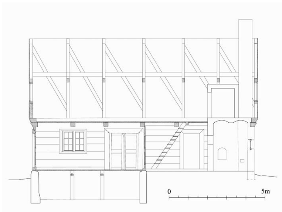
Il. 15. Mątwoskie Pastwiska 30, dom dla pracowników rolnych, rekonstrukcja przekroju podłużnego; oprac. M. Prarat
